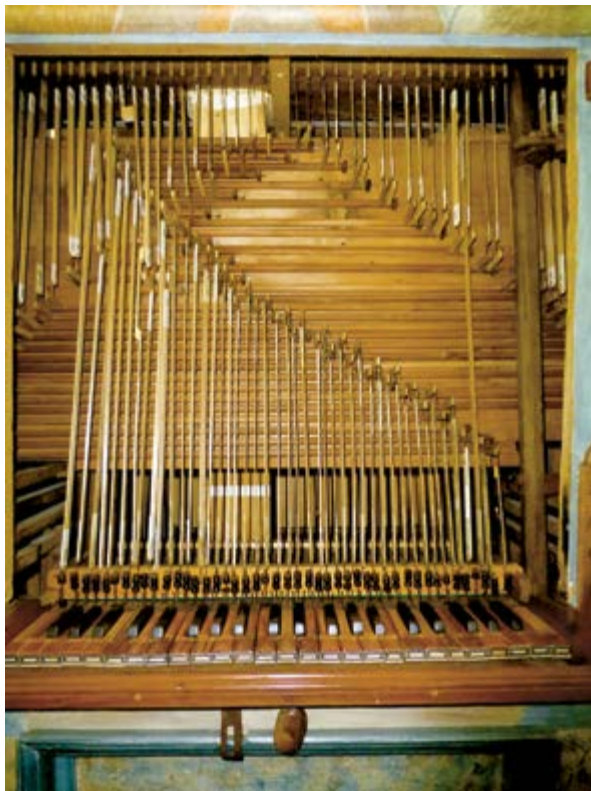
Abb. 10: Vignogn, Orgel von Pankratius Kayser, erbaut 1782, Blick aufs Wellenbrett unter der Manualwindlade; gut erkennbar sind die jeweils zwei Abstrakten der Doppelventile (Bassbereich), die sich an der Welle vereinigen, welche mit einer Taste des Manuals verbunden ist (Foto: Markus Meier, 2020).
